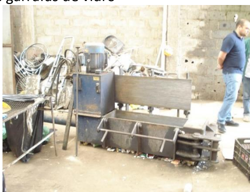
Equipamento para prensagem de latinhas de alumínio
