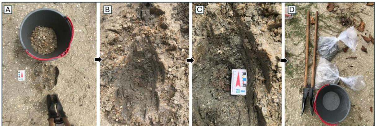
Figura 7: A) Coleta de amostra no ponto S-CEN-01. B) Retirada no ponto A, coletado a uma profundidade de 5 cm. C) Retirada no ponto B, coletado a uma profundidade de 30 cm. D) Materiais utilizados.
